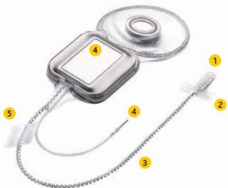
Figura 5: caratteristiche dell'elettrodo di impianti uditivi al tronco encefalico Cochlear Nucleus ABI541
